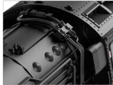
■ Freistehende Leitungen vor dem Führerhaus
